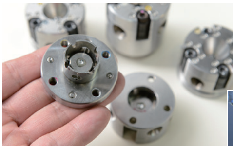
超高压発生装置ダイヤモンドアンビルセルとその内部の拡大図。地球中心を超える超高压 超高温の発生が可能
