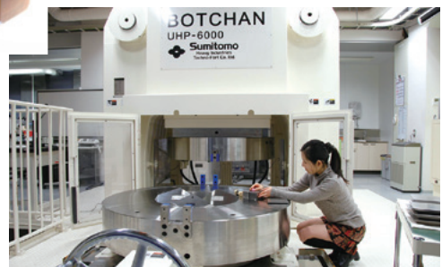
愛媛大学サテライトに設置されている世界最大のマルチアンビル型高压発生装置と多結晶ダイヤモンド
